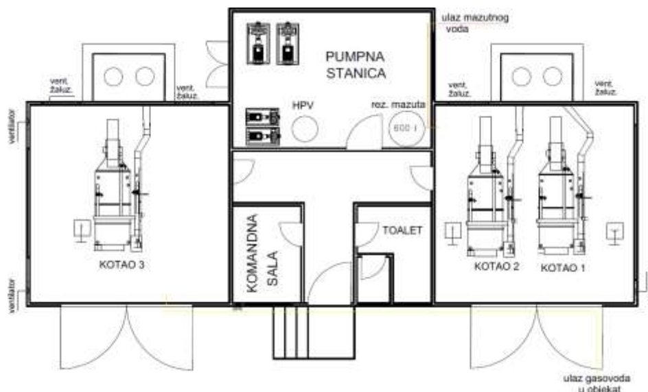
Слика 17. Приказ распореда просторија у котларници ТО „Дудара“
